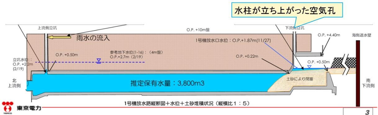
図 4-4 福島第一発電所の南放水口は津波が運び込んだ土砂で閉塞した
