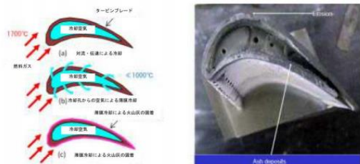
タービンプレードの冷却による火山灰の影響 (左)模式図、(右)付着事例 (安田・他, 2011)
