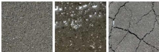
火山灰の状態 (左から乾燥時・湿潤時・湿潤後の乾燥時) (有珠山2000年噴火の火山灰を用いた室内実験)
