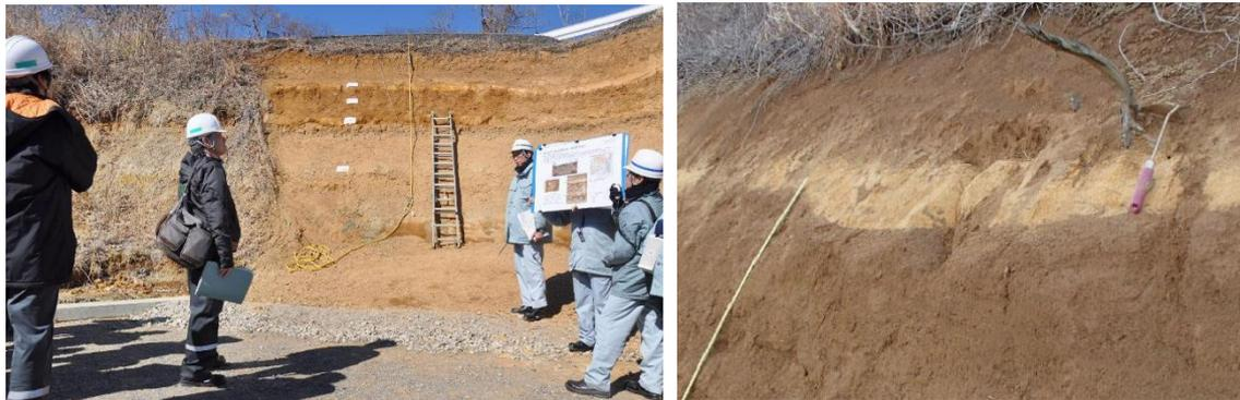
写真左は 2017 年 2 月の規制委現地調査（茨城県東海村）。写真右は東海地点⑥の赤城鹿沼テフラの露頭。この時点で日本原電は赤城テフラの層厚を 40cm から 20cm に切り下げようとした。これに対し規制委石渡委員は、「地層の上端がでこぼこだ。火山灰が降った後に削られて厚さが減った可能性がある」と指摘し、「もう少し調査が必要だ」と述べ、原電に想定の見直しを求めた。最終的に赤城テフラの層厚は 40cm と評価され、想定すべき火山灰層厚は 50cm とされた。
